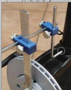
Regolare le aste graduate sino a toccare l'asola di fissaggio ammortizzatore
