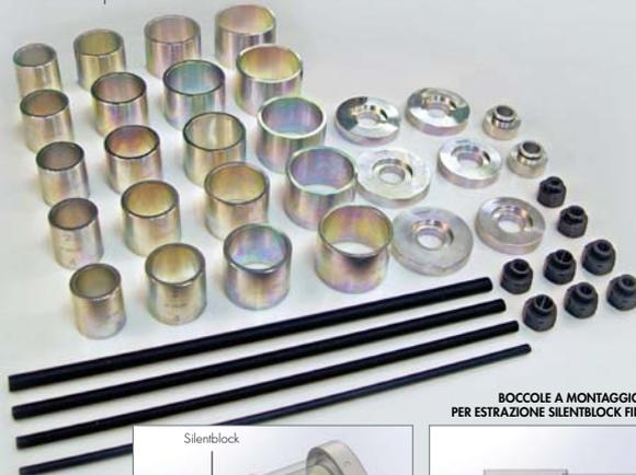
BOCCOLE A MONTAGGIO MODULARE PER ESTRAZIONE SILENTBLOCK FINO A L = 100
