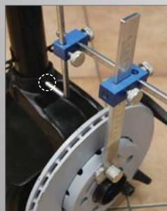
Svitare il bullone sulla flangia senza modificare la posizione delle aste graduate e procedere al fissaggio del kit sul mozzo opposto
