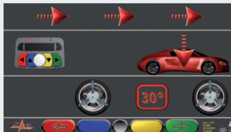
É possibile la misurazione del fuori centro spingendo il veicolo di 30° (compensazione rapida e in poco spazio)\* senza necessità di sollevare il veicolo.
