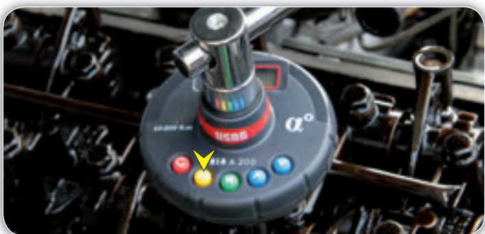
Possibilità di passare da serraggi coppia a quelli angolo premendo un solo tasto
