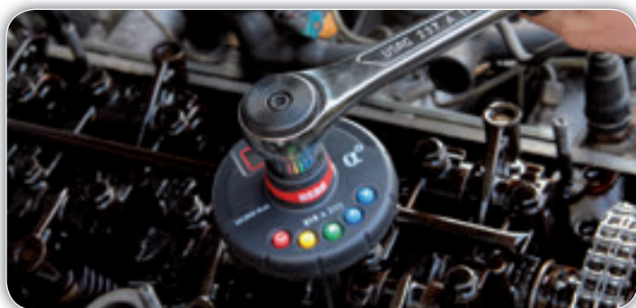
Serraggi coppia angolo di precisione digitale usando utensili tradizionali
