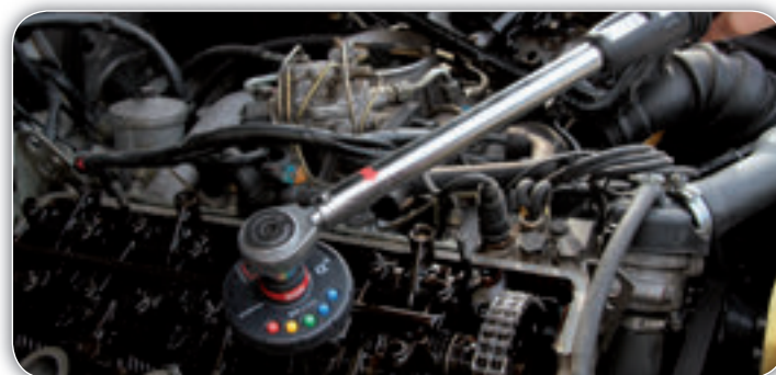
Possibilità di verifica taratura della chiave dinamometrica meccanica
