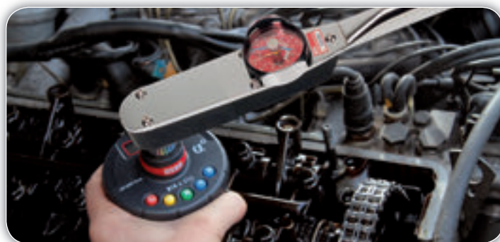
Serraggi digitali coppia-angolo con chiavi dinamometriche meccaniche
